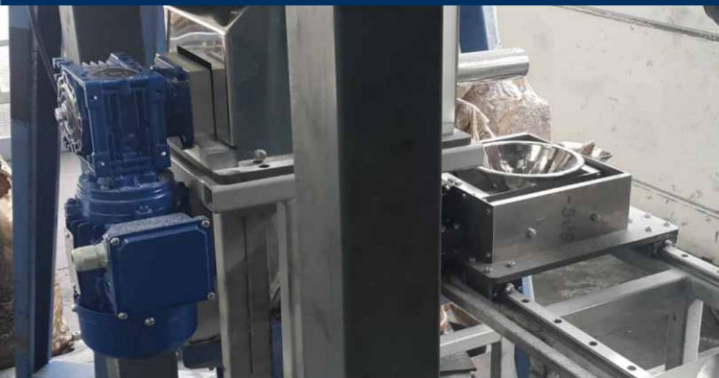
Doziranje PVC granulata v dva industrijska mešalnika. Izvedba s integrirano industrijsko vago in zelo natančnim doziranjem z našim produktom "Micro-Batch Feeder". Dobili smo 1g odstopanja pri doziranju.
